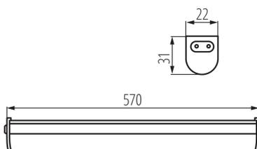
L'apparecchio sotto mensola Kanlux LINUS LED è caratterizzato dal design classico e universale. Grazie alle sue dimensioni compatte la lampada è ideale per illuminare diversi tipi di mobili, mobiletti e mensole. Kanlux LINUS LED può essere montato in maniera passante tramite il cavo LINUS LINK.
