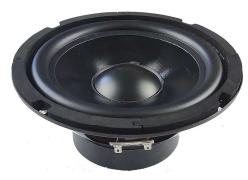
Woofer 165mm 6.5" 8 Ohm 90W Caratteristiche Potenza RMS: 30W Potenza di picco: 90W Impedenza: 8 Ohm Sensibilità: 90dB Dimensioni Diametro altoparlante: 165mm Dimensioni in pollici: 6.5" Altezza: 75mm (interna 66mm) Diametro magnete: 90mm Spessore magnete: 20mm Diametro foro: 155mm (+/- 3mm) Distanza fori in diagonale: 157mm Distanza fori in orizzontale: 110mm
