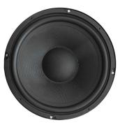
Woofer 25.5cm 4 Ohm 400W Caratteristiche Impedenza: 4 Ohm Diametro: 25.5cm Diametro magnete: 14 cm Profondità: 12cm circa Distanza tra i fori in diagonale: 24.5cm Distanza tra i fori: 17.5cm circa Potenza di picco: 400W Potenza RMS: 200W
