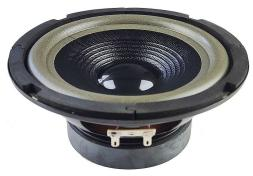
Woofer 165mm 6.5" 8 Ohm 100W Caratteristiche Potenza RMS: 30W Potenza di picco: 100W Impedenza: 4-8 Ohm Sensibilità: 90dB Dimensioni Diametro altoparlante: 165mm Dimensioni in pollici: 6.5" Altezza: 74mm (interna 66mm) Diametro magnete: 100mm Spessore magnete: 18mm Diametro foro: 155mm (+/- 3mm) Distanza fori in diagonale: 157mm Distanza fori in orizzontale: 110mm
