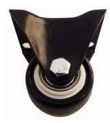
Ruota in gomma con piastra fissa 50x69mm Diametro ruota: 45mm Distanza centro fori: lato lungo 51mm, lato corto 35mm
