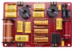
Filtro crossover 3 vie 800W 4-8 Ohm Caratteristiche Modello: CW-3806 Potenza massima: 800W Impedenza: 4-8? Risposta in frequenza: 45Hz-28KHz Lunghezza: circa 250mm Larghezza: circa 164mm Altezza: circa 45mm Installazione della distanza centrale del foro: 230x148mm Colore: rosso
