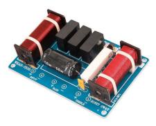
Filtro crossover 2 vie 300W 4~8 Ohm WEAH 2506A Caratteristiche Tipo di prodotto Audio Crossover Modello WEAH - 2506A Potenza 300W Dimensioni scheda 144x94 (mm) Riposta in frequenza 50hz - 22KHz Distanza tra i fori 134x84mm Numero di vie 2 Impedenza 4~8? Caratteristiche Frequenza bidirezionale alta e bassa Specifiche audio 12db/oct
