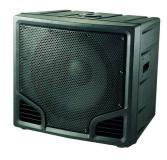
Realizzato in ABS 2 Uscite amplificate per casse passive Stativo in metallo per il montaggio di casse esterne. 18"SUBWOOFER Magnet 100 oz Voice Coil 4"BASV Frequency Response 35HZ-3KHZ Sensitivity 98dB( /-2dB) Impedance 8 ohm RMS Power 300W Amplifier(A) PP-24118A Impedance 8 ohm . 110/220V/AC/60-50 HZ Power max Voltage 600 W
