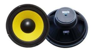
Woofer 165mm 80W 8 ohm W-068 Impedenza (Z): 8? Frequenza di risonanza (fs): 45Hz Banda passante: f3-3500Hz Potenza max.: 80WMAX Potenza nominale (P): 50WRMS SPL (1W/1m): 92dB Elasticità sospensione (Cms): 0,75mm/N Massa mobile (Mms): 16,7g Fattore Q mecc. (Qms): 3,96 Fattore Q elett. (Qes): 1,35 Fattore Q totale (Qts): 1,00 Volume equivalente (Vas): 48 I Resistenza ohmica (Re): 7,8? Fattore di forza (BxL): 4,8Tm Induttività bobina (Le): 0,6mH Supporto bobina mobile: alluminio
