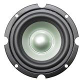
Woofer 76mm 8 Ohm 10W Potenza max: 10W Impedenza 8 Ohm Diametro totale: 90mm Dimensione magnete: Ø 65mm Profondità di montaggio: 45mm Diametro foro: 78mm
