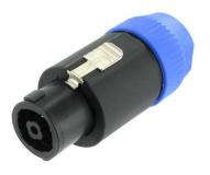
Connettore Speakon 4 poli maschio Connettore Speakon per il collegamento professionale di altoparlanti. Connettore speakon maschio, contatto a vite a 4 poli per conduttore flessibile fino a 4mm2, Ø cavo 8-20mm. Versione robusta, con blocco, protetta contro il contatto accidentale, passacavi a morsetto. Caratteristiche Potenza massima dei contatti: 30ARMS Resistenza di contatto: ? 3m? Tensione d'esercizio: 250V~ (segnale efficace) Autoestinguente secondo: UL-94V0
