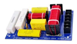
Filtro crossover 2 vie 160W 4~8 Ohm WEAH 2504 II filtro crossover adotta condensatori audio speciali MKP di grandi dimensioni, resistori ad alta potenza e induttori di grande diametro. Caratteristiche Tipo di prodotto Audio Crossover Modello WEAH - 2504 Potenza 160W Dimensioni 137\*90\*30 (mm) Frequency Point 3200Hz Impedenza 4~8? Numero di vie 2 Specifiche audio 12db/oct : 2600Hz
