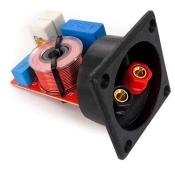
Morsettiera per altoparlanti con filtro crossover incorporato 4-8 ohm 80W N.B: Alcuni dettagli, come i colori dei componenti elettronici, potrebbero variare da quelli mostrati in immagine Caratteristiche Potenza massima: 80W Risposta in frequenza: 48Hz - 20K Hz Impedenza: 4 - 8 Ohm 2 vie Dimensioni del circuito stampato: 45x56mm Dimensioni morsettiera: 55x55mm
