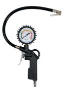
Pistola con manometro per pneumatici 1/4" Vorel Una pistola con un manometro per il gonfiaggio. Ha un cavo da 35 cm con valvola in metallo. Un grande manometro leggibile facilita il dosaggio preciso della pressione. Attacco pneumatico standard da 1/4". Lo strumento non è destinato all'uso con pneumatici per autoveicoli.
