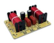
Filtro crossover 3 vie 150W 4~8 Ohm WEAH 305 Caratteristiche Tipo di prodotto Audio Crossover Modello WEAH - 305 Potenza 150W Dimensioni scheda 85x62x30mm(mm) Frequenze medio-alto: 4000Hz/medio-basso: 900Hz Distanza tra i fori 75x52mm Numero di vie 2 Impedenza 4~8? Caratteristiche Frequenza bidirezionale alta e bassa Specifiche audio 12db/oct
