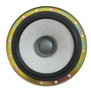
Woofer a doppio cono 6.5" 16.5cm 40W SP675K L'altoparlante da 6,5 ??pollici SP675K può essere utilizzato come sostituzione per sistemi audio di auto o altri impianti audio. Caratteristiche Dimensioni: 6.5" Diametro: 16.5cm Modello: SP675K Potenza RMS: 20W Potenza massima: 40W Doppio cono Distanza tra i fori: 3cm Distanza tra gruppi di fori: 6cm Diametro magnete: 7.4cm circa Profonfità: 5.5cm circa
