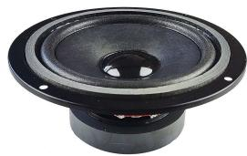
Woofer 145mm 8 ohm 60W Caratteristiche Potenza RMS: 20W Potenza di picco: 60W Impedenza: 4-8 Ohm Sensibilità: 90dB Dimensioni Diametro altoparlante: 145mm Altezza: 61mm (interna 55mm) Diametro magnete: 80mm Spessore magnete: 15mm Diametro foro: 117-125mm Distanza fori in diagonale: 138mm Distanza fori in orizzontale: 97mm
