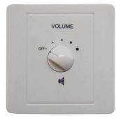
Regolatore di volume a pannello 20W Controlli progettati per consentire la regolazione del volume o lo spegnimento dei diffusori in ogni zona dove richiesto. E' possibile utilizzarne uno in ogni zona oppure per più zone, basta non variare la potenza totale massima applicabile. Il commutatore a 5 posizioni consente una regolazione del volume precisa e adatta ad ogni esigenza. Dimensioni 85x85x35
