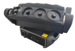
Testa mobile RGB spider laser Caratteristiche Tensione in ingresso: AC220-240V 50/60Hz Connettori: Presa di alimentazione 3 poli 1x maschio-1x femmina, XLR femmina 3 pin per ingresso DMX, XLR 3 pin maschio per uscita DMX Potenza laser: R: 200mW/637nm, G: 80mW/532nm, B: 500mw/445nm Vibrating mirror: 20K Metodi di controllo: controllo audio / Auto / master, slave / DMX512 angolo di rotazione: 540° orizzontale, 120° verticale Peso: 8 kg circa Dimensioni: 58x46x32cm
