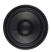
Mini woofer 3" 77mm 15W 8 Ohm Caratteristiche Dimensioni: 3" Diametro altoparlante: 77mm Diametro foro: 70mm Altezza 38mm (interna 35mm) Dimensione magnete: 60x10mm Impedenza: 4-8 ohm Potenza RMS: 10W Potenza di picco: 30W Sensibilità: 90dB Cono in carta
