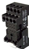
Zoccolo con morsetti a vite per relè a 2 scambi ES 15 /2B Grado protezione: IP20 Connessione elettrica: 1 ÷ 2,5 mm 2 Temp. Funzionamento: - 25 ÷ 85°C Fissaggio: a parete o a guida DIN Predisposizione per moduli di protezione
