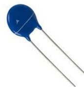
Varistore 25V AC - confezione 10 pezzi Marca: EPCOS P.N.: B72205S250K101 Tensione DC: 31V Tensione AC: 25V Tensione varistore: 39V Confezione 10 pezzi
