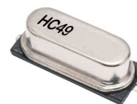
Quarzo smd 4 MHz Contenitore: HC49/4HSMX SMT Precisione: 50ppm Capacità risonanza: 16pF Confezione 10 pezzi
