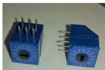
Dip switch rotari encoder 16 posizioni Marca: ALCO Modello: DRD-16RA
