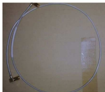
Cavo RF preassemblato tipo UT-085 Connettori: SMC-SMC Impedenza: 50 ohm lunghezza: 80 cm Produttore: ROSENBERGER P/N: C39195-Z80-C117
