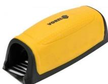
Raspa in metallo per cartongesso 140x50mm Vorel Raspa destinata alla levigatura di cartongesso. Lunghezza raspa 140 mm, larghezza 50 mm. Il corpo dell'utensile è in plastica, la lama/grattugia con profilo del dente specifico/ è in acciaio inox. La raspa può
